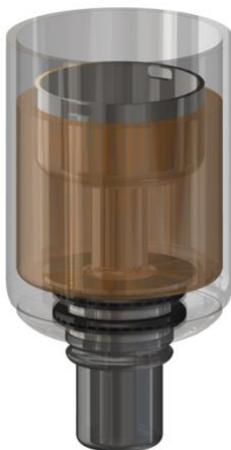
*In configurazione standard il carico del liquido su Sputnik RTA avviene “dal basso”. Porre l’insieme tank/campana a testa in giù e procedere al riempimento avendo cura di non versare liquido all’interno della campana e di non superare il livello indicato in figura.*
