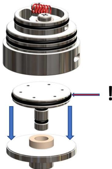
*Il corretto riassettaggio della parte inferiore del deck prevede prima di tutto di inserire bene a fondo lo Sputnik Air Disk nell'isolatore del positivo. Durante questa operazione ponete attenzione allo stato dell'oring indicato in figura e, se deteriorato, sostituitelo con uno di riserva.*
