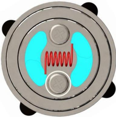
*Questa seconda modalità prevede di montare la coil perpendicolare alle viti del deck e di porre il cotone, sempre opportunamente lavorato, ad occupare tutta l’area evidenziata senza necessità di pressarlo eccessivamente sulle vasche ma avendo cura che siano completamente coperte. Questa rigenerazione consente una riduzione del volume della camera di vaporizzazione ed un flusso d’aria più “guidato” verso la coil.*
