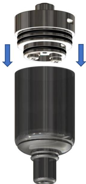
*Dopo aver effettuato il refill procedere alla chiusura dell'atomizzatore inserendo il deck nel tank capovolto. Prima di effettuare questa operazione avere cura di lubrificare tutti gli orings del deck. Ponete attenzione ad effettuare l'operazione in maniera verticale e delicatamente onde evitare di rovinare gli orings.*
