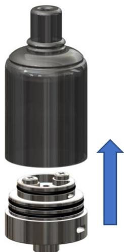
*Per procedere all'apertura del Tank e guadagnare l'accesso al deck, tirare il Tank verso l'alto avendo cura di eseguire un movimento longitudinale onde evitare di rovinare l'oring di tenuta sul deck.*
